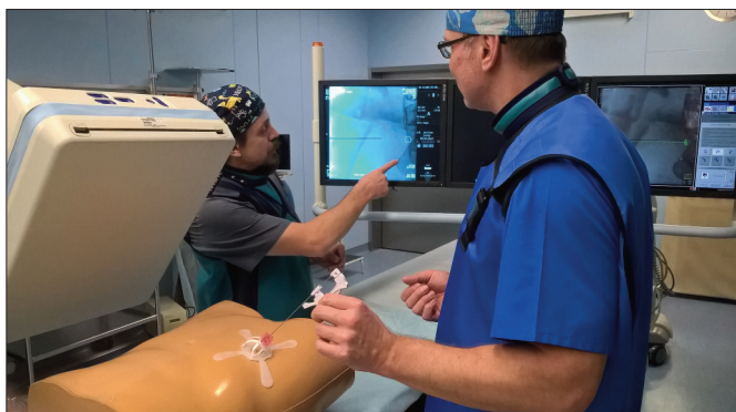
Рис. 3. Оценка точности позиционирования механической системы наведения SeeStar (AprioMed, Швеция), используемой в комбинации с ПДКТ-навигацией на ангиографическом комплексе Artis Zee Floor (Siemens, Германия) в рентгеноперационной ОРХМДил. Первым этапом выполняется ПДКТ, после чего на рабочей станции ангиографа строится траектория таргетирования. После этого С-дуга устанавливается в прямую проекцию атаки (положение «вид сверху»). Система SeeStar приклеивается к коже лепестками в месте вкола и разворачивается таким образом, чтобы ее направляющая металлическая канюля приобрела вид «о», то есть стала видна «на просвет». Угол атаки SeeStar фиксируется специальным зажимом, а С-дуга переводится в боковую проекцию. Дальнейшее продвижение иглы (аппликатора) до целевой точки контролируется в режиме реального времени на флюороскопическом мониторе (отражено на фотографии). Использование SeeStar в сочетании с ПДКТ позволяет обеспечить более точное позиционирование игл (аппликаторов), снизить лучевую нагрузку на пациента, а также избежать облучения рук рентгенохирурга.
